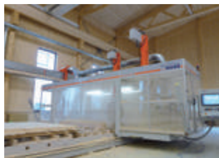
das Abbundportal le portique de taille the joinery machine
