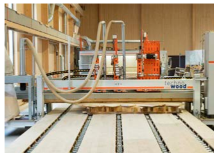
das Bohr- und Dübelportal le portique de perçage et de chevillage the drill and dowel portal
