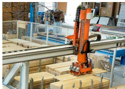
das Legeportal le portique de pose the planting portal
